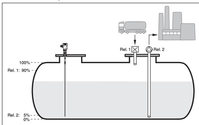
Рис. 13: Пример измерения уровня в горизонтальной цилиндрической емкости
