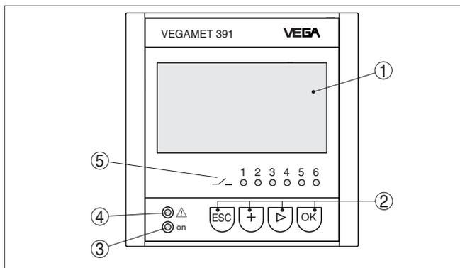
Рис. 7. Элементы индикации и настройки
