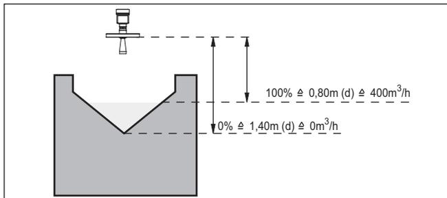
Рис. 19: Установка для измерения расхода с треугольным водосливом
