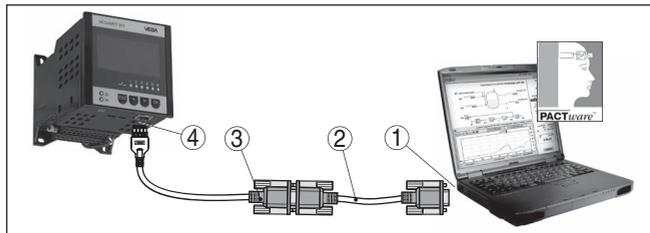
Рис. 11: Подключение ПК через RS232
