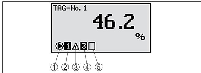
Рис. 15: Индикация управления насосами на дисплее
