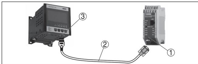
Рис. 10: Подключение модема через RS232
