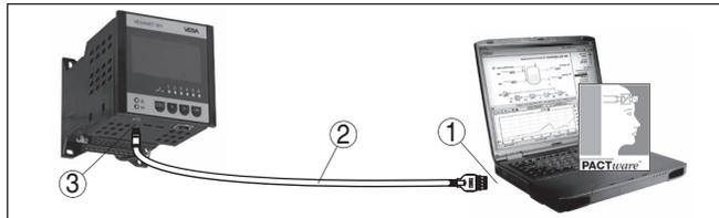
Рис. 8: Подключение ПК через USB
