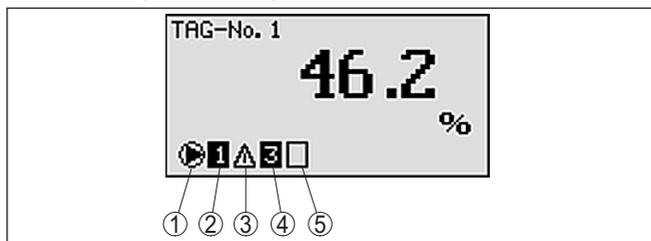
Рис. 17: Индикация управления насосами на дисплее
