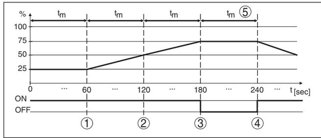
Рис. 18: Пример сигнализации тенденции
