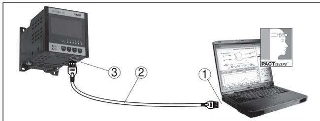
Рис. 9: Подключение ПК через Ethernet
