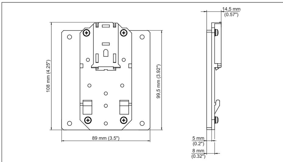
Рис. 22: Размеры дополнительного адаптера для несущей рейки
