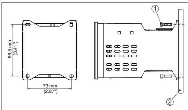
Рис. 3: Монтаж на винтах
