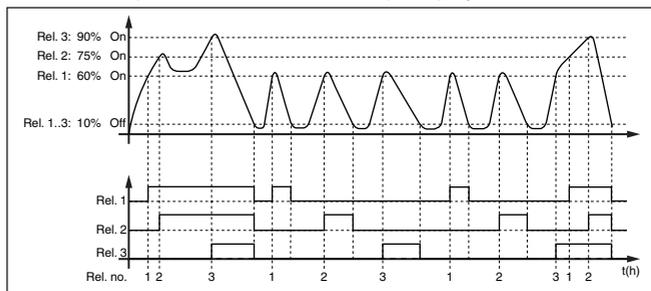
Рис. 16: Пример управления насосами 4
